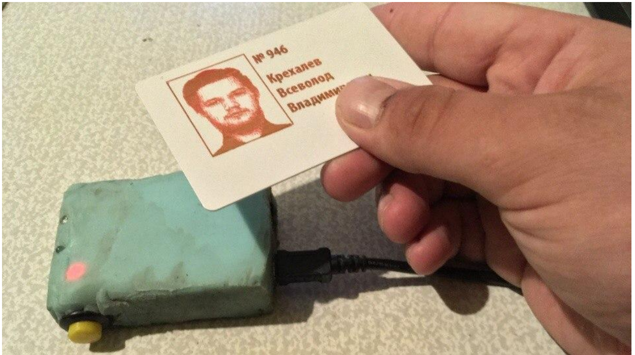
Рис. 5 Поднесение персонализированной метки к RFID сканеру
