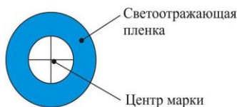
Специальные марки для лазерного сканера Leica ScanStation 2
